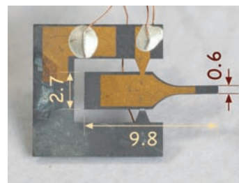
図3 内視鏡下の手術向けに研究中のマイクロスマートメス
